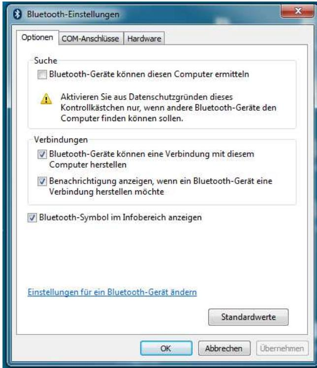
Wählen Sie die Registerkarte „COM-Anschlüsse“ aus um sich die jetzt zur Verfügung stehenden (virtuellen) COM Ports für den BlueSerial Adapter anzeigen zu lassen.
